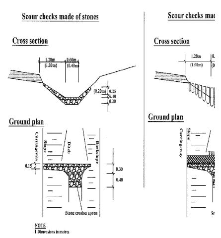
STONE WEIGHT:MIN 10KG STAKE DIAMETER: MIN. 0.10
