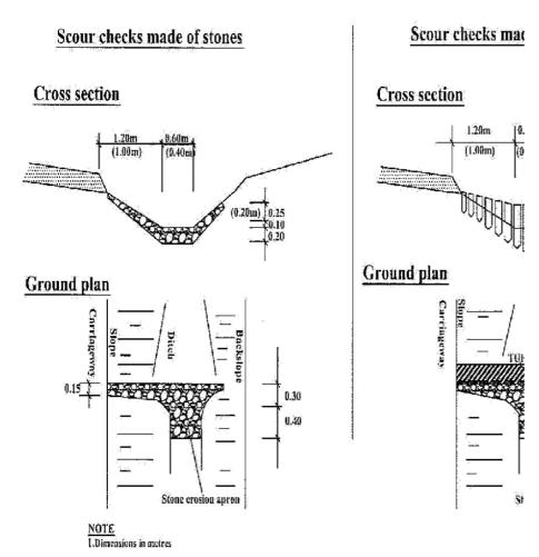
STONE WEIGHT:MIN 10KG STAKE DIAMETER: MIN. 0.1(
