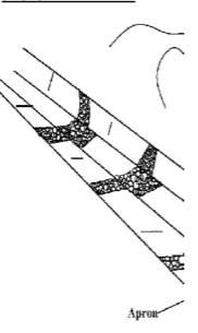
STONE WEIGHT:MIN 10KG STAKE DIAMETER: MIN. 0.10
