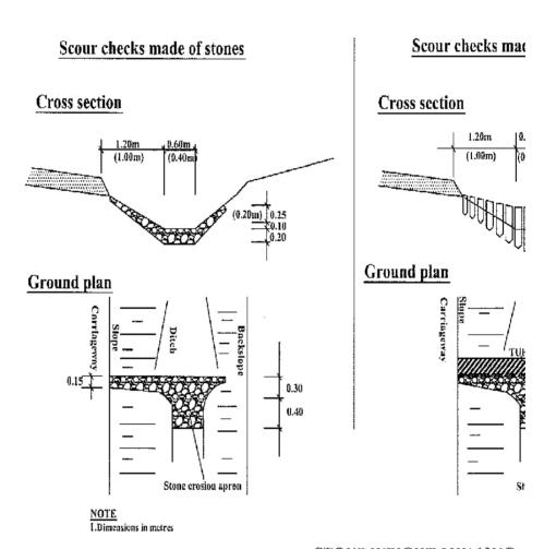
STONE WEIGHT:MIN 10KG STAKE DIAMETER: MIN. 0.1(
