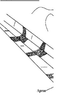
STONE WEIGHT:MIN 10KG STAKE DIAMETER: MIN. 0.1(
