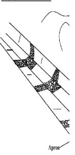
STONE WEIGHT:MIN 10KG STAKE DIAMETER: MIN. 0.10
