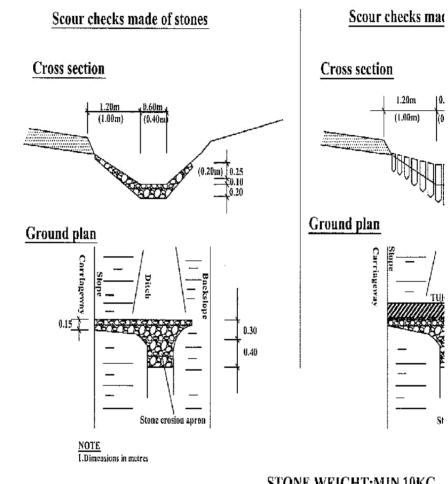
STONE WEIGHT:MIN 10KG STAKE DIAMETER: MIN. 0.1(
