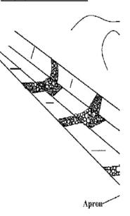
STONE WEIGHT:MIN 10KG STAKE DIAMETER: MIN. 0.1(
