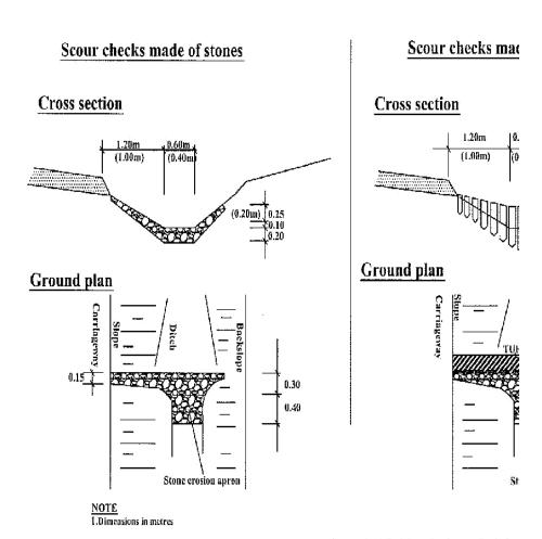
STONE WEIGHT:MIN 10KG STAKE DIAMETER: MIN. 0.1(
