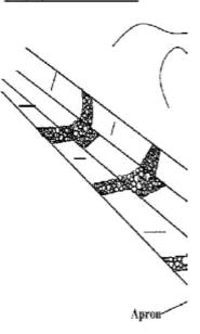
STONE WEIGHT:MIN 10KG STAKE DIAMETER: MIN. 0.10
