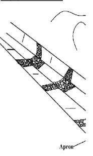
STONE WEIGHT:MIN 10KG STAKE DIAMETER: MIN. 0.1(
