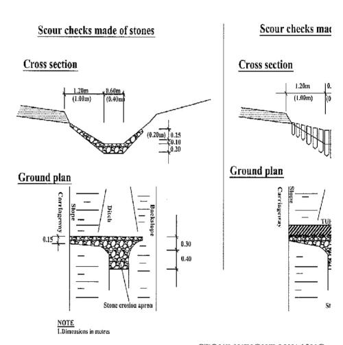
STONE WEIGHT:MIN 10KG STAKE DIAMETER: MIN. 0.1(
