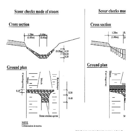
STONE WEIGHT:MIN 10KG STAKE DIAMETER: MIN. 0.1(
