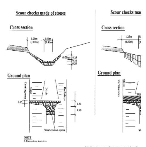
STONE WEIGHT:MIN 10KG STAKE DIAMETER: MIN. 0.10
